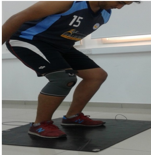
Şekil 2.Soft Diz Ortezi Kullanılarak Yapılan Dikey Sıçrama Testi
