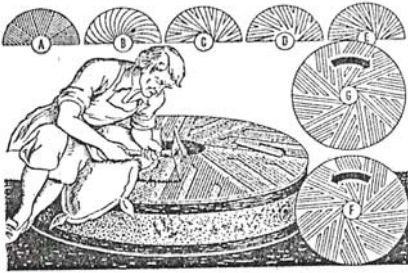
Şekil 10. Değirmen taşlarının buğdayı daha iyi öğütmek için düzenli bir şekilde taraklanırdı (Forbes??). Sağda ise taşların kaldıraçla nasıl kaldırıldığı görülmektedir.
