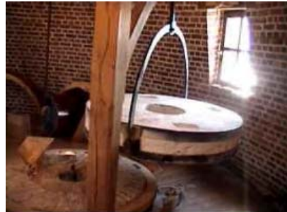
Şekil 10. Değirmen taşlarının buğdayı daha iyi öğütmek için düzenli bir şekilde taraklanırdı (Forbes??). Sağda ise taşların kaldıraçla nasıl kaldırıldığı görülmektedir.
