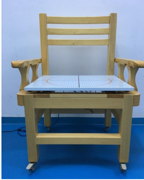
Şekil 3: Kuvvet Platform Sandalyesi
