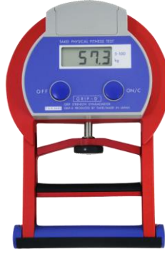
Şekil 8: Takei marka (GRIP-D) dijital hand grip dinamometresi
