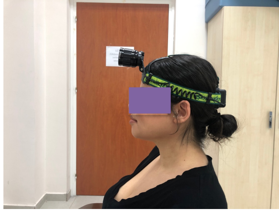
Şekil 12: Servikal bölgenin pozisyon hissi ölçümü için lazer imleç yerleşimi
