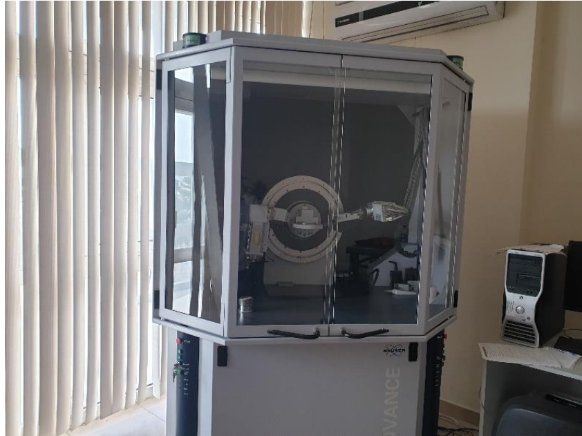
Şekil 95: XRD deney süreci (Soyk k 2023)
