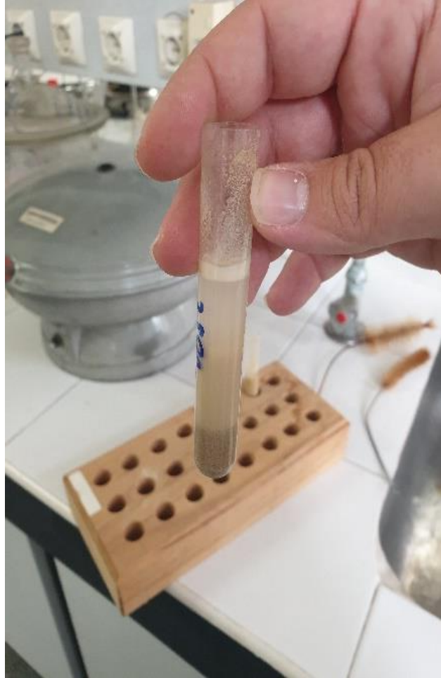
Şekil 96: Suda çözünen tuz testi (Soykök 2023)
