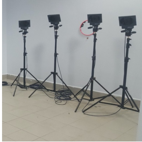
Şekil 16. BTS Smart-DX 100 cihazına ait infrared kameralar.
