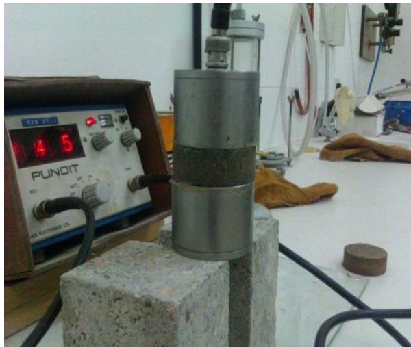
Figure 17: Ultrasonic pulse velocity test apparatus (Pundit)
