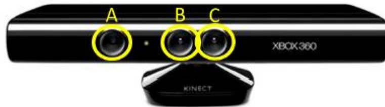
Şekil 1: A: Lazer Projektör, B: RGB Kamera, C: CMOS Kamera
