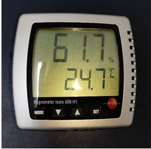
Şekil 3.2: Isı ve bağıl nem ölçer
