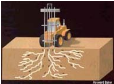
Şekil 3. Sorunlu zemine uygulanan püskürtme metodu
