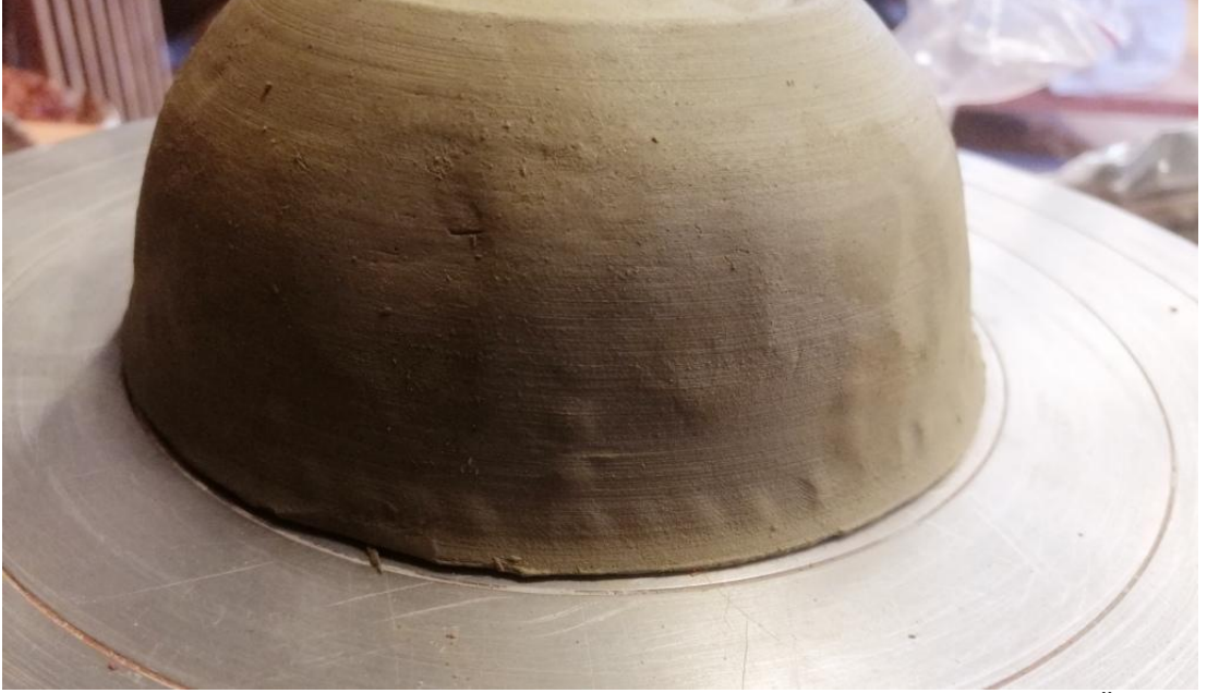
Şekil 80: Dekorlanan Kalıpların Dış Yüzeyindeki Düzensizlikler (Foto: Taner Özgür)
